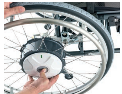
Abnehmen der Antriebsräder per Schnellentriegelung
