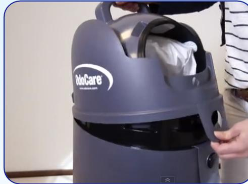
2. Halten Sie den Hebel der Trommel fest und ziehen Sie den Deckel nach oben über die Trommel weg.
